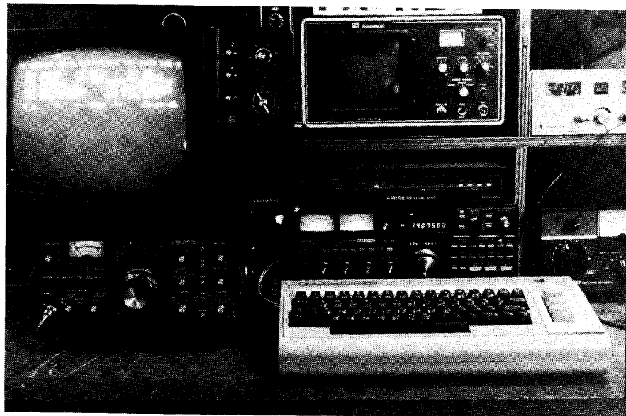
Foto 2. Het AMTOR-station in bedrijf, frequentie 14.075 MHz. U heeft ongetwijfeld het 'krekelgeluid' wel eens gehoord.
